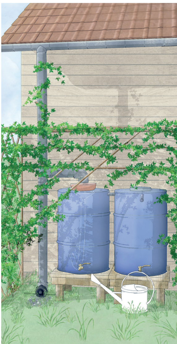
System zum Sammeln von Dachwasser.
