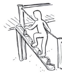
Eingekerbter Stamm mit einem seilgeführten Handlauf
